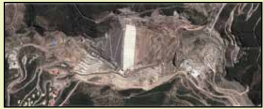
نگاره ۶-ج- نماهایی از سد سنگریزه ای با پوشش بتنی سیاه بیشه-جاده چالوس (عکس ماهواره ای از google earth).
